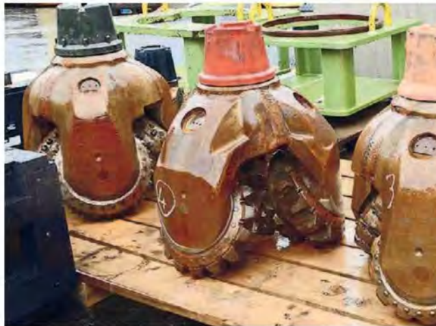
Mit diesen Bohrköpfen wird die Bohrung vorangetrieben. Je nach Gesteinsart sind sie mit Zahn-, Warzen- oder Diamantmeissel bestückt. In jeder Sektion wird das Bohrloch rund zehn Zentimeter kleiner.
